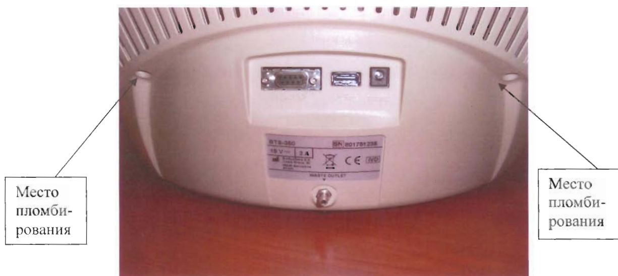
Рисунок 2 - Места пломбирования анализатора биохимического полуавтоматического BTS-350
